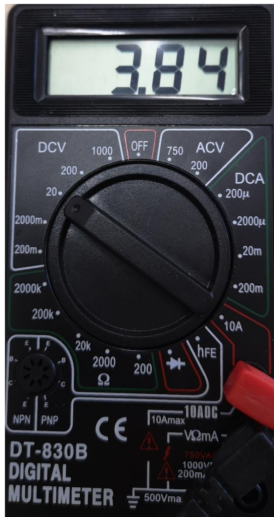
2 pav. Šaltinio elektrovara išmatuota multimetru.
