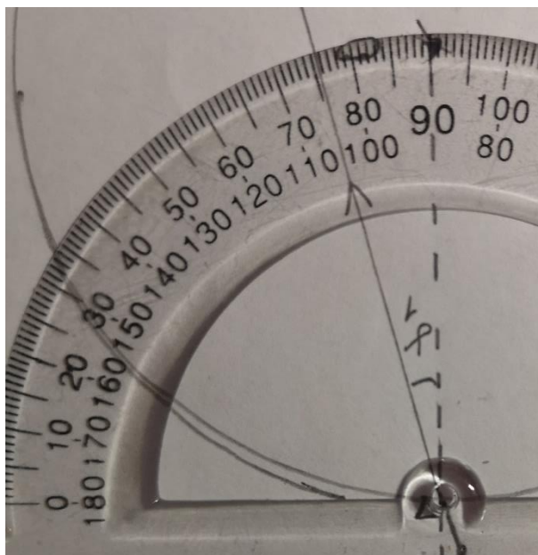
8 pav. Išmatuotas lūžio kampas \gamma_1 3 būdu.
